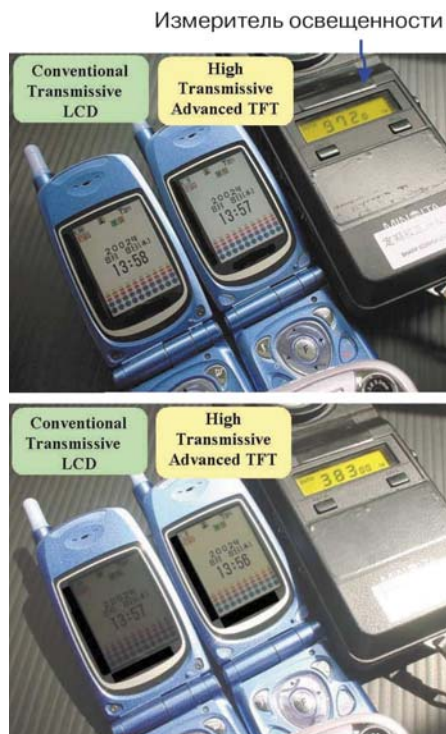
Рис. 8. Изображения на экране дисплеев с режимами подсветки transmissive и high transmissive при разных уровнях освещенности
